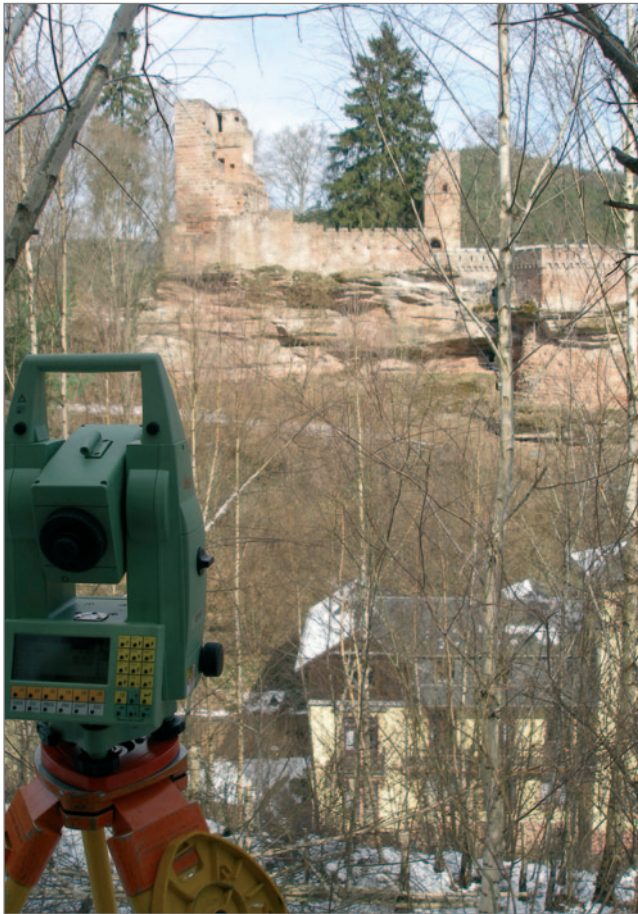
Abb. 5: Berührungsfrei messendes Tachymeter, hier an der Burgruine Diemerstein (Verf. 2012). Mittels eines Laserpunktes können am Gebäude beliebig viele Punkte eingemessen und räumliche Koordinaten berechnet werden.
