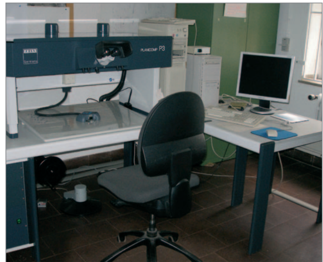
Abb. 12: Analoges stereoskopisches Auswertegerät Zeiss Planicomp P3 (in Verbindung mit einer Rolleimetric 6006, Format 6 x 6), das Mitte der 1980er Jahre von der TU Kaiserslautern angeschafft wurde (Verf. 2010).
