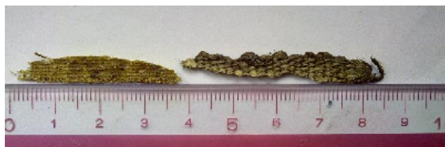
19a. Tela a Monaco. Piccoli pezzi tagliati dalla tela per facilitare l'esame. A sinistra tela dell'800 usata come fodera al bordo rovinato in alto, con la fittezza del tessuto data da ca. 16 fili di trama al cm; a destra tela di uso dal 600 alla metà del 700 con la fittezza del tessuto di ca. 9 fili di ordito e 7 fili di trama al cm.
