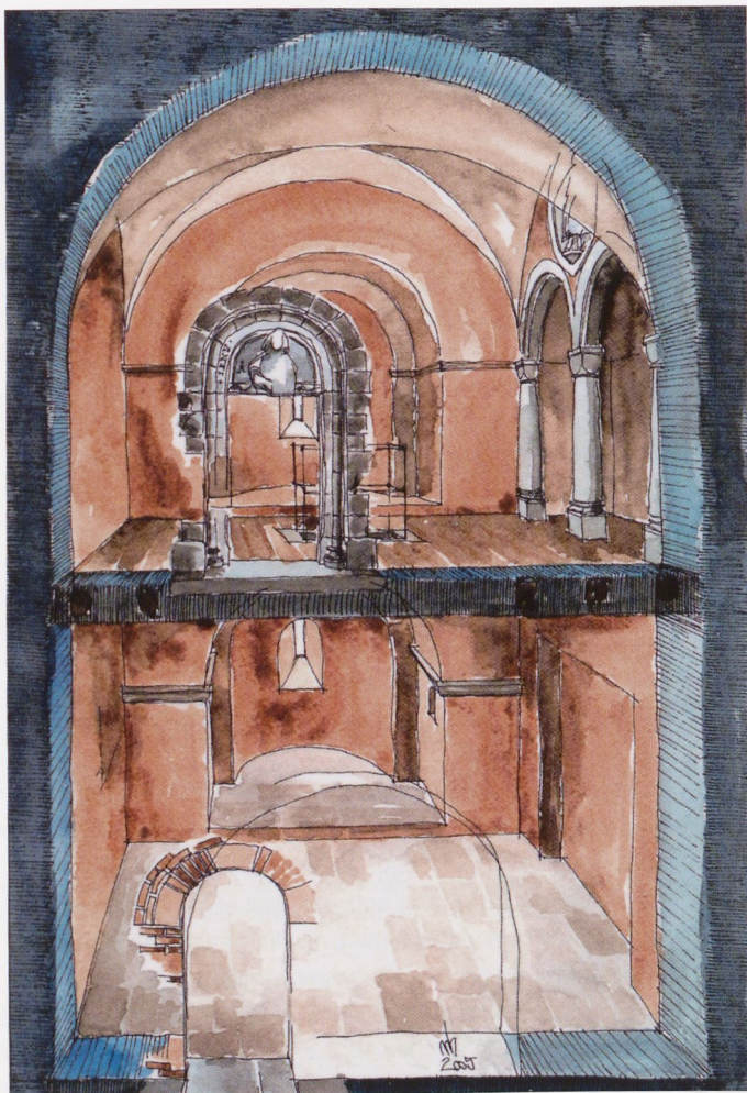
Abb. 2 Greiz (Thüringen), Oberes Schloss, Rekonstruktion der romanischen Doppelkapelle nach der ab 2004 durchgeführten Bauforschung. In der großen Burg, deren äußeres Erscheinungsbild weitgehend durch spätere Umbauten geprägt ist, wurden ein Palas und eine Doppelkapelle als frühe Backsteinbauten festgestellt (um 1188).
