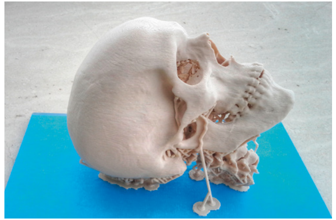
Abb. 7: An diesem aus Computertomografie-Daten erstellten Schädel eines Menschen sind die für den 3D-Druck notwendigen Stützstrukturen gut zu erkennen (Foto: Nevit Dilmen, CC BY-SA 3.0).
