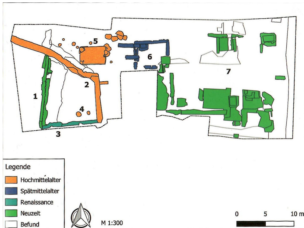
Abb. 5: Gesamtplan der Ausgrabung aus dem Jahr 2018, Nummer 2 ist die Kontermauer des Burggrabens.
