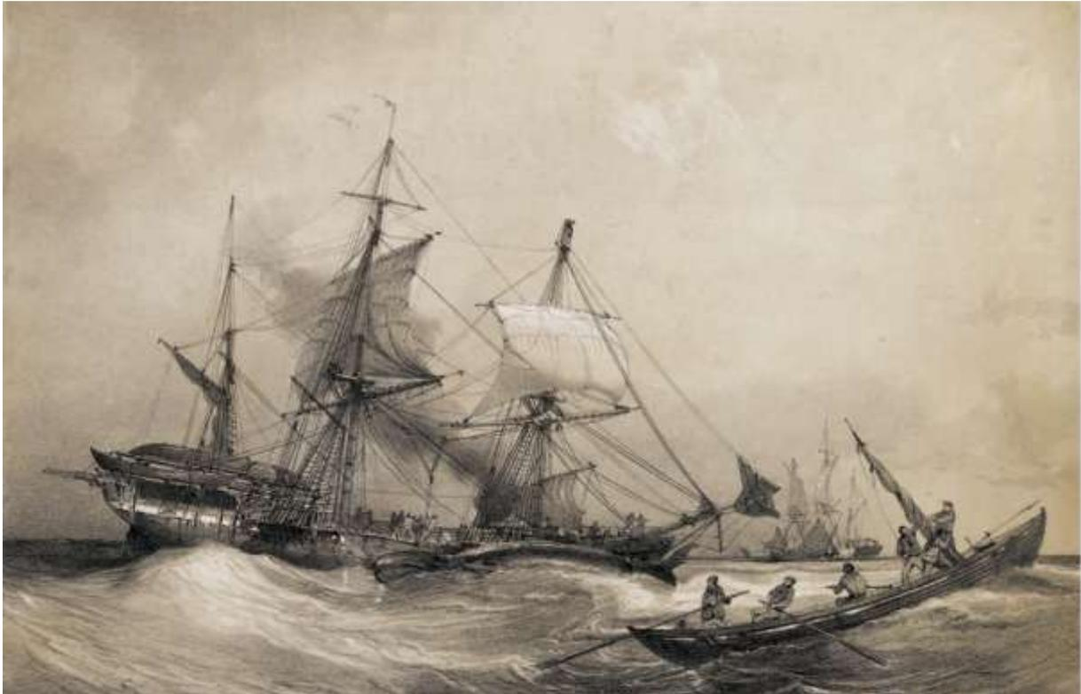
*Abb. 49. Ein französisches Walfangschiff liegt unter Vor- und Großmarssegel beigedreht. Zur leichteren Handhabung ist die Bramstenge am Fockmast gestrichen und das Großbramssegel ist nicht angeschlagen. Ein längsseits liegender Wal wird abgeflent. Der Speck wird ausgekocht, wie der schwarze Qualm zeigt. In Vordergrund ein Walfangboot, bei dem der Mast gelegt wird. 1844/45. Quelle: Barthelmess 2007, Abb. 1.*
