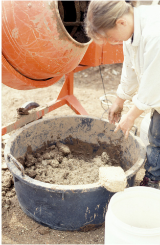
Abb. 7: Herstellung von Lehmziegeln, Murlo. Prüfung der Tonmischung.
