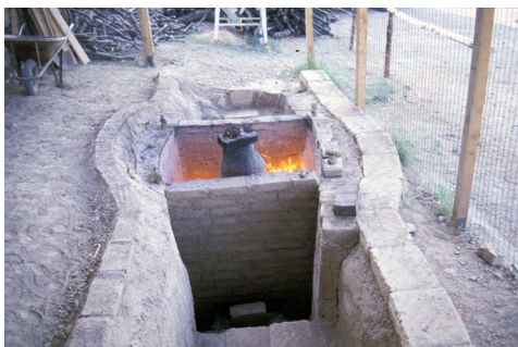
Abb.16: Ausheizen der Form. Murlo. Die Grube wurde dabei mit zwei Wänden aus Lehmziegeln verkleinert. Nach dem Auftrag von mehreren Schichten des Tons lässt sich die ursprüngliche Form nicht mehr erkennen.
