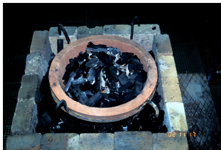
Abb. 17: Nach dem Befund in Olympia rekonstruierter Gusstiegel. Aachen, Gießerei-Institut. Der Tiegel ist in eine mit Schamotte ausgekleidete Blechkiste gestellt und mit Holzkohle überhäuft.
