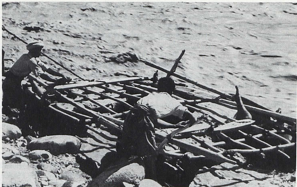
Abb. 1. Schlauchfloß, das im Hunza-Fluß verwendet wurde. Als Tragkörper dienen vier aufgeblasene Rinderhäute. Aufnahme Jettmar 1955
