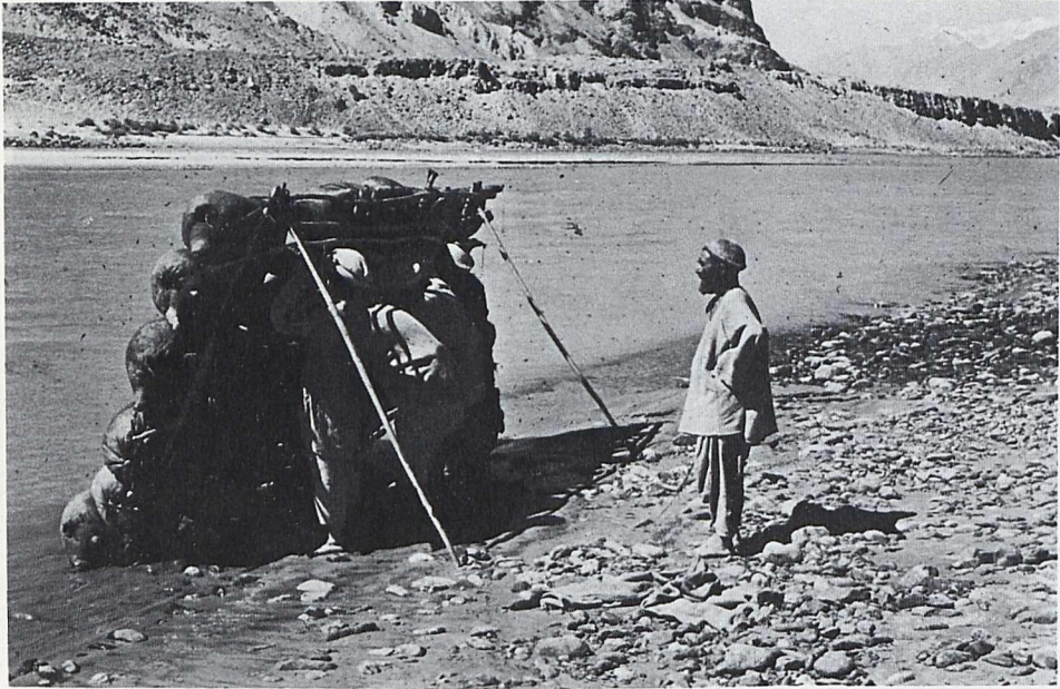
Abb. 2. Schlauchfloß für die Verwendung im Shigar-Fluß Baltistans. Die Mannschaft ist noch dabei, die Bälge aufzublasen und zu befestigen. Aufnahme Jettmar
