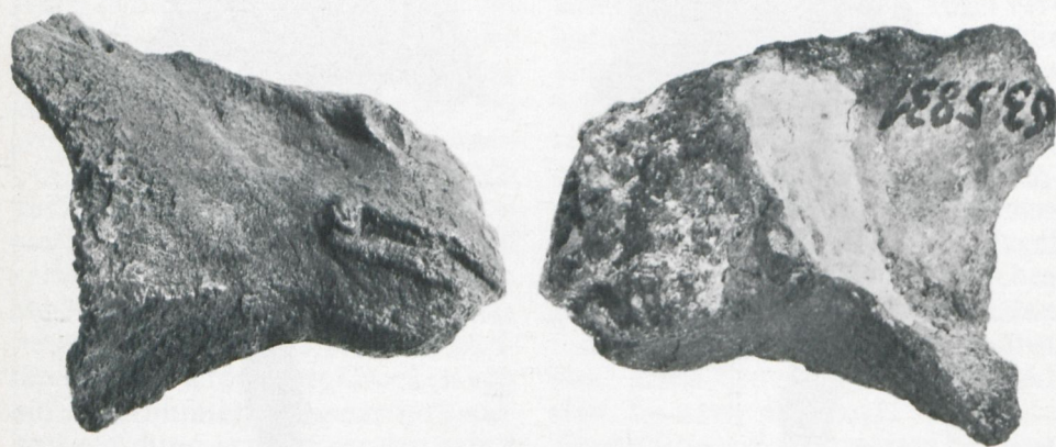
Abb. 11 Fragment einer missratenen Pferdestatue oder -protome aus Bronze; im Innern Rest des Tonkerns. M. 1:1. Foto C. Zimmer. Fragment d'une statuette de cheval en bronze, ratée; à l'intérieur un reste du noyau en terre cuite. Frammento di una statuetta di cavallo di bronzo mal riuscita; all'interno un resto della forma d'argilla.
