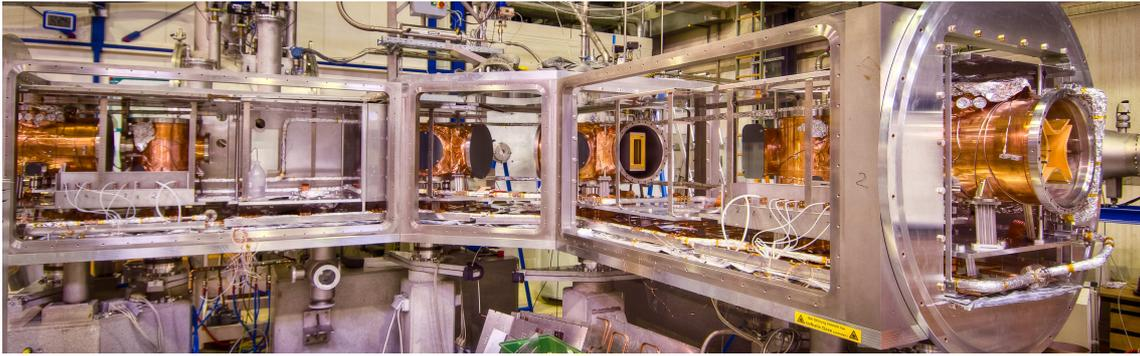
Abbildung 1.4: Ansicht einer Ecke des CSR. Zu sehen sind einige der inneren sowie äußeren Vakuummkammern mit demontierten Seitenplatten. Auf diese wirken im evakuierten Zustand Kräfte von bis zu 368 kN.
