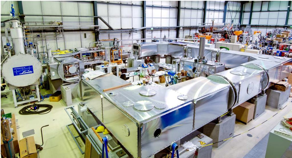
Abbildung 5.1: Gezeigt ist das im Rahmen dieser Arbeit aufgebaute Isoliervakuumsystem des CSR, sowie im oberen linken Bereich im Anschluss an die Linde Kälteanlage, die erste Ecke. Die Strahlungsschilde sind teilweise demontiert, so dass teilweise die inneren Vakuumkammern zu erkennen sind.
