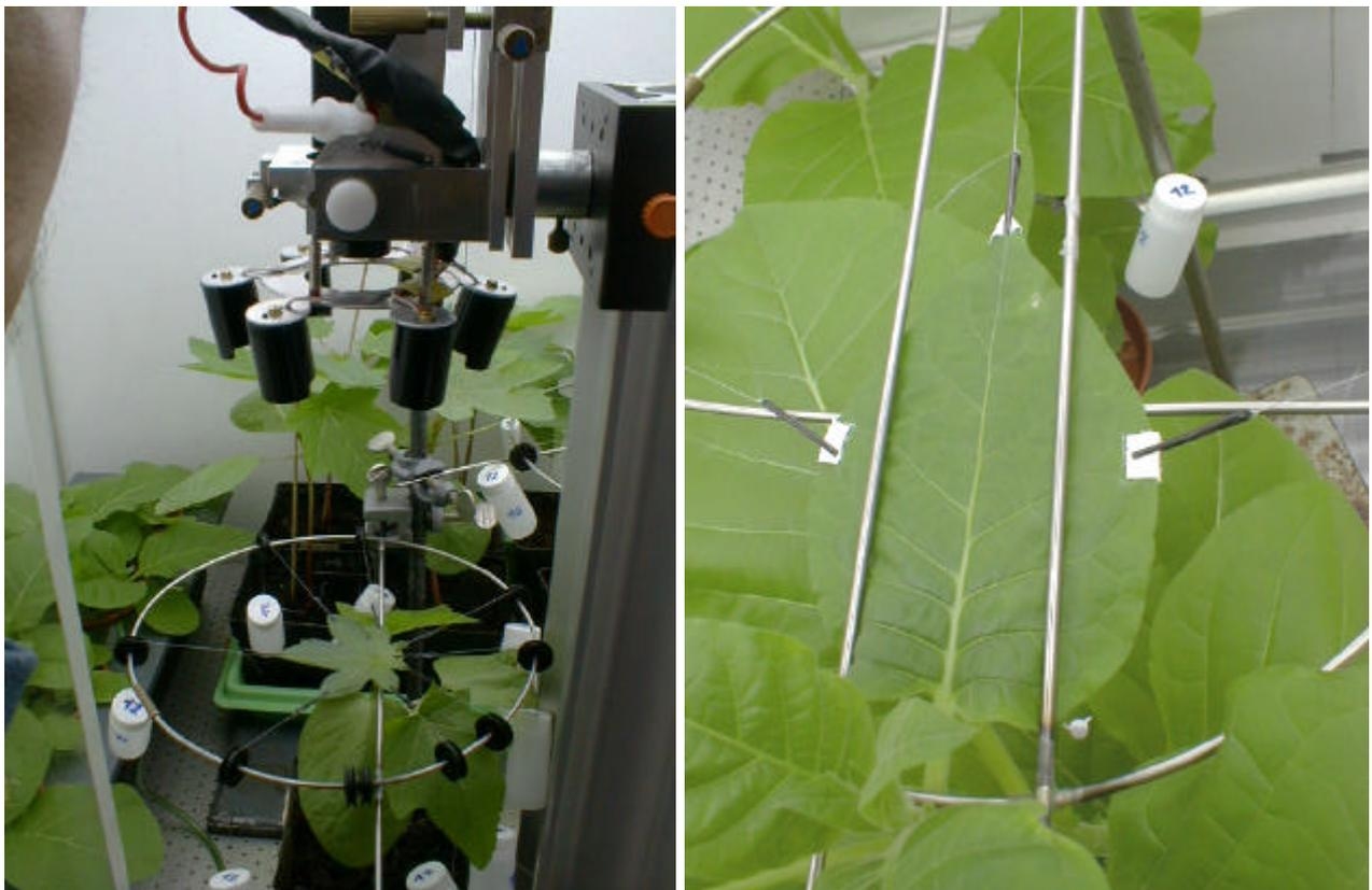
Abb. 4.6 DISP-Aufbau und Blattfixierung bei Aufnahme von Rizinus (links) bzw. Tabak (rechts)
