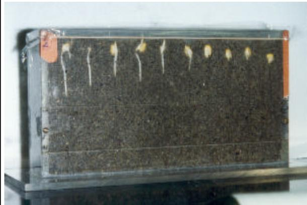
Abb. 2.3 Sand-Rhizotron aus Davis für pH-Versuch
