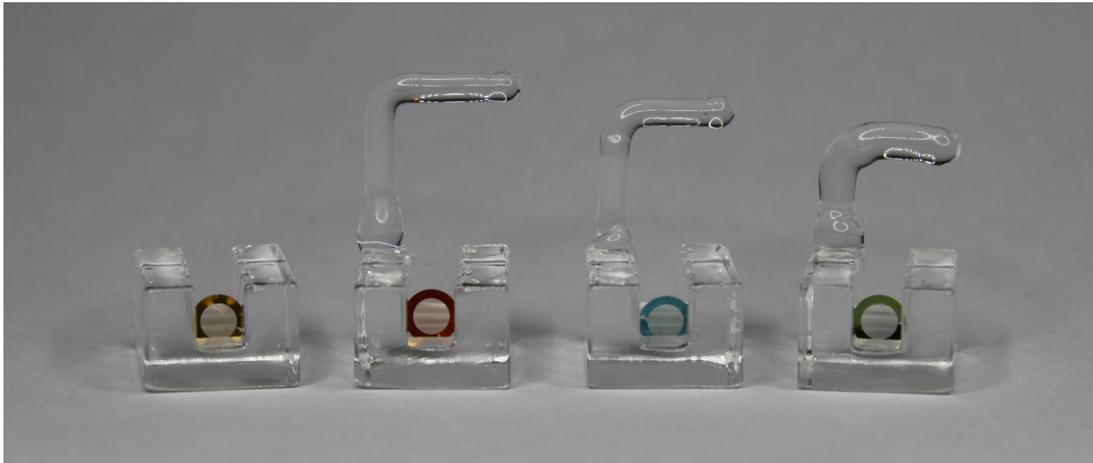
**Abbildung 5.9:** Titanbeschichtete Au-TEM-Gitter. Aufgrund der Dünnschichtinterferenz zeigen verschieden dicke  $\text{TiO}_2$ -Schichten unterschiedliche Färbungen, was eine instantane Abschätzung der Höhe ermöglicht. Von links nach rechts unter Angabe der Dicke und Beschichtungsdauer: gelb (60-80 nm, 200 s), rot (80-100 nm, 250 s), blau (100-130 nm, 350 s), grün (130-160 nm, 450 s).
