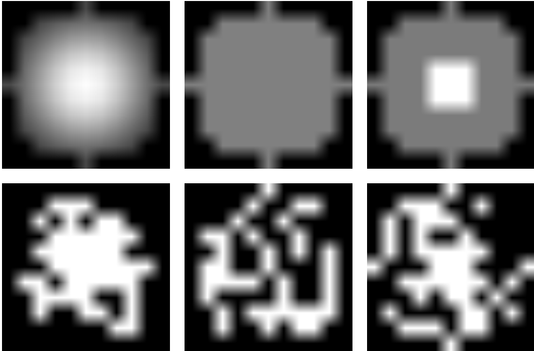
Abbildung 3.4: Abtastwahrscheinlichkeiten und entsprechende Abtastungsmuster im q-Raum. Erste Zeile: Abtastwahrscheinlichkeiten im q-Raum, gezeigt an dessen zentraler Schicht, für einen Beschleunigungsfaktor von zwei, kodiert in Graustufen (weiß: Wahrscheinlichkeit 1, schwarz: Wahrscheinlichkeit 0). Von links nach rechts: gaußförmig, rein zufällige und zufällige aber mit immer abgetasteten q-Raum Zentrum. Zweite Zeile: Exemplarisch jeweils ein entsprechendes Abtastungsmuster.
