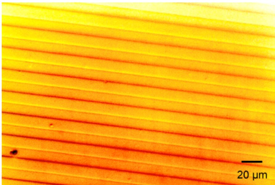
**Abbildung 3-5** Dies ist die Linienstruktur eines pH-sensitiven P(MAA-g-EG)-Hydrogels. Die Breite der Gelbalken beträgt 10 µm. Der Mittenabstand ist 20 µm.
