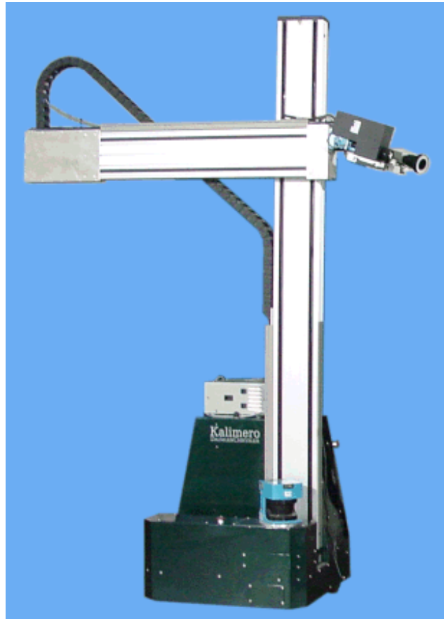
Abbildung 5.10: Der autonome Messroboter Kalimero verfügt über sechs Freiheitsgrade und trägt den Ganymed Sensor. Er navigiert auf dem Marken-Feld des Messobjektes und verfügt über eine adaptive Strategie zur Wahl des günstigsten Aufnahme-Standortes.
