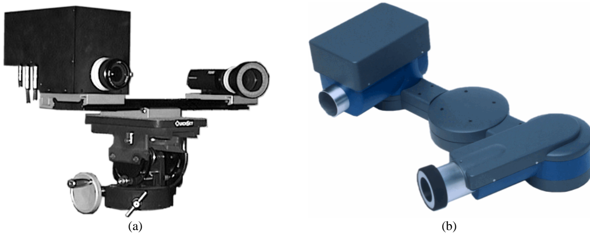
Abbildung 1.1: Der Ganymed -Messkopf bestehend aus Kamera, Projektor und Ringlichtquelle. In a) ist der Prototyp aus dem Jahr 1997 dargestellt, b) zeigt den Sensor im Design-Gehäuse von 1999. Die Konstruktion des Gehäuses erlaubt die Konfiguration des Sensors für unterschiedliche Messvolumina und -abstände ohne Austausch von Gehäuseteilen oder Änderung der Verkabelung.
