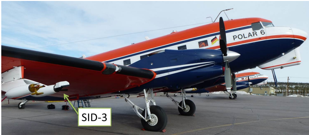
Abbildung 3.22: Fotografie des SID-3 unter dem Flügel der Polar-6. Aufgenommen vor einem Messflug während RACEPAC auf dem Mike Zubko Flughafen von Inuvik ( 68,3^{\circ}\text{N} ; 133,4^{\circ}\text{W} ), NWT, Kanada. Im Hintergrund ist die baugleiche Polar-5 zu sehen.
