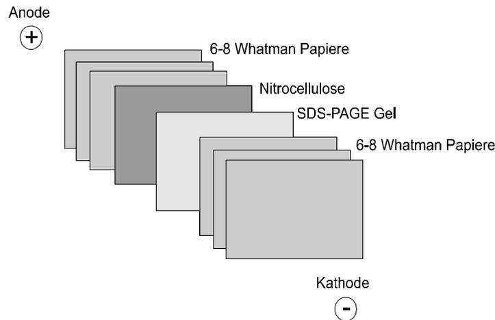
**Abbildung 9. Aufbau des Blotes**
