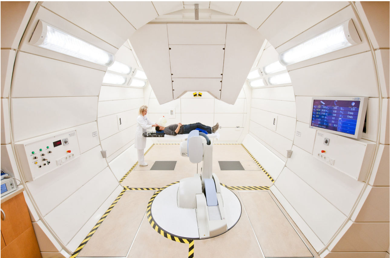
Abbildung 5: Gantrystrahlplatz (Roboter mit Patiententisch, im Hintergrund der drehbare Teil des Raumes mit Nozzle inkl. Flachdetektoren, oben, und im Fußboden versenkten Röntgenstrahlern, unten)
