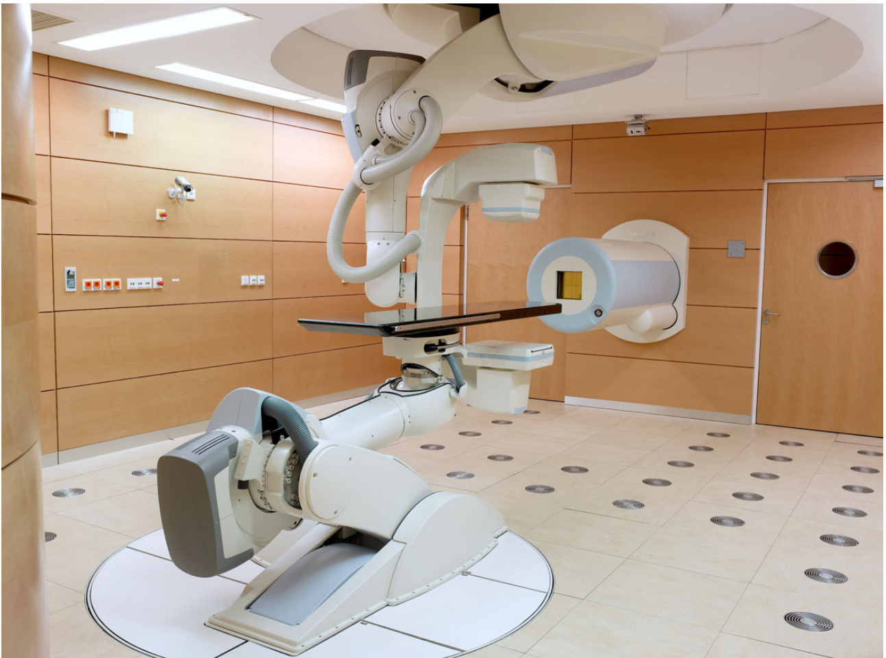
Abbildung 4: Horizontalstrahlplatz 2 (Roboter mit Patiententisch, Robot Imager in Bildgebungsposition, im Hintergrund das BAMS)
