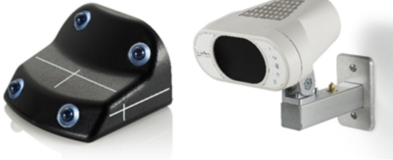
Abbildung 2.2: Varian RPM (Real-Time Position Management System) zum Aufnehmen der Brustkorb Amplitude der Patienten während des CBCT Scans. Die Position des Markerblocks (links) mit Infrarotreflektoren wird dabei kontinuierlich mit der Kamera (rechts) verfolgt. Die Amplitude des Brustkorbs wird damit zu jeder aufgenommenen Projektion gespeichert. Aus der Amplitude lässt sich dann die Atemphase bestimmen.
