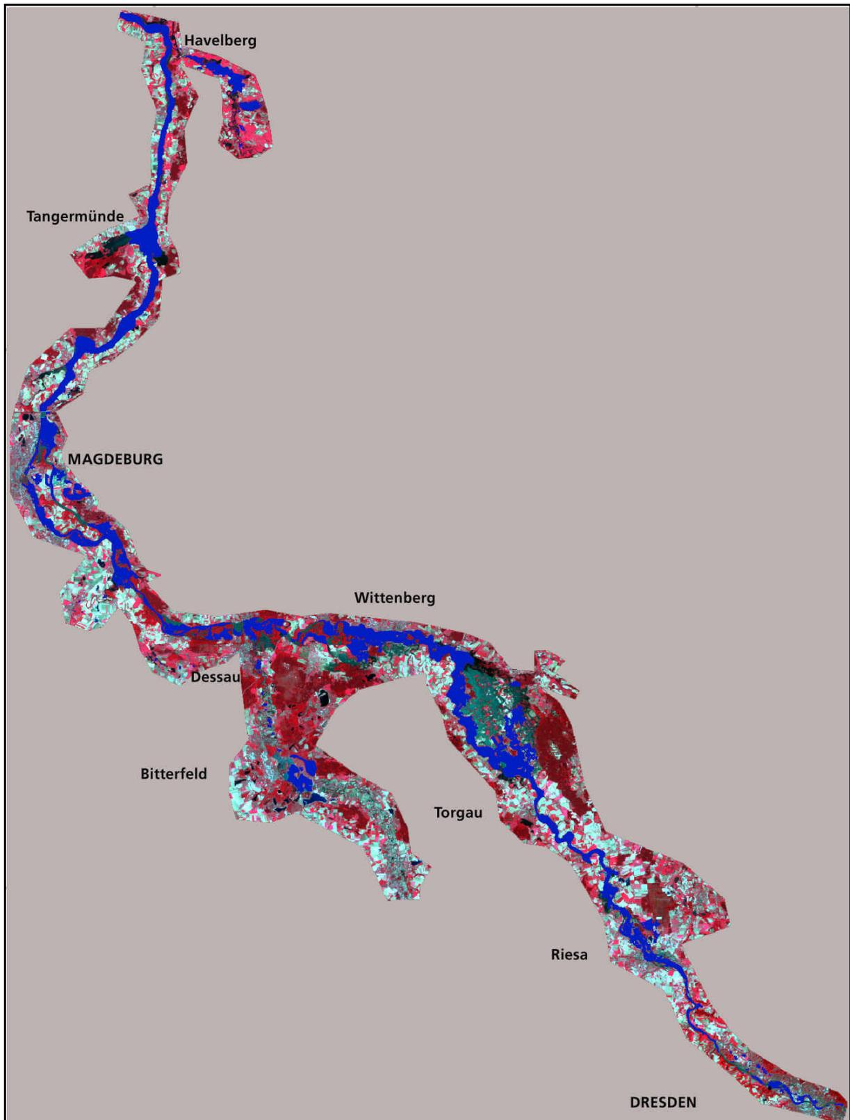
**Abb.1.:** Beispiel für eine Satellitenbild basierte Inundationsflächenkarte. Dargestellt ist das Ausmaß der Überschwemmungen des Elbhochwassers am 20.8.2002 zwischen Dresden und Havelberg. Sensor: ETM+; Satellit: Landsat 7; Kanäle: 4,3,2; Farbgebung: Vegetation=rot; Brachflächen=grau; Wasser=blau;
