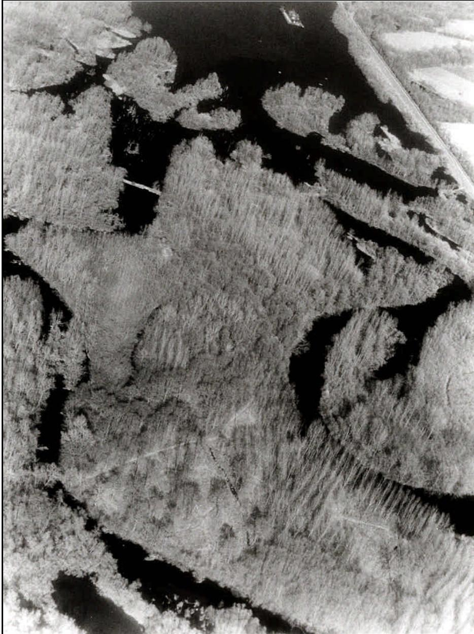
**Abb. 32.:** Rheinarme im Taubergießen bei Freiburg während des Februarhochwassers 1999. Die Aufnahme verdeutlicht eindrücklich, dass durch die Nutzung IR empfindlicher Filme (High Speed Infrared von Kodak) in Kombination mit einem Schwarzfilter eine deutliche Unterscheidung von Wasser (schwarz) und nicht-Wasser (grau/weiß) erreicht werden kann.
