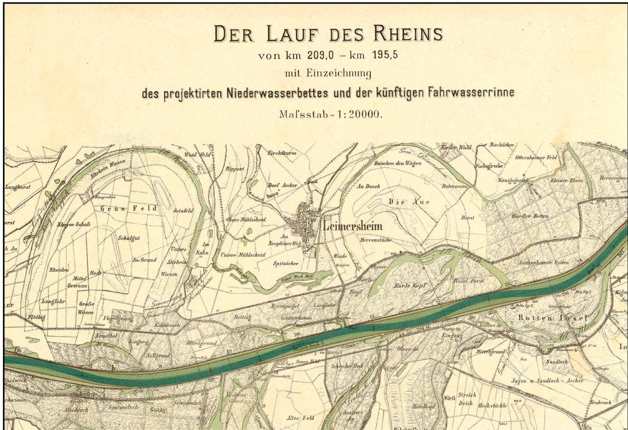
**Abb. 23.:** Ausschnitt aus Max Honsells Plänen für den Bau einer auch bei Niedrigwasser befahrbaren Schiffahrtsrinne
