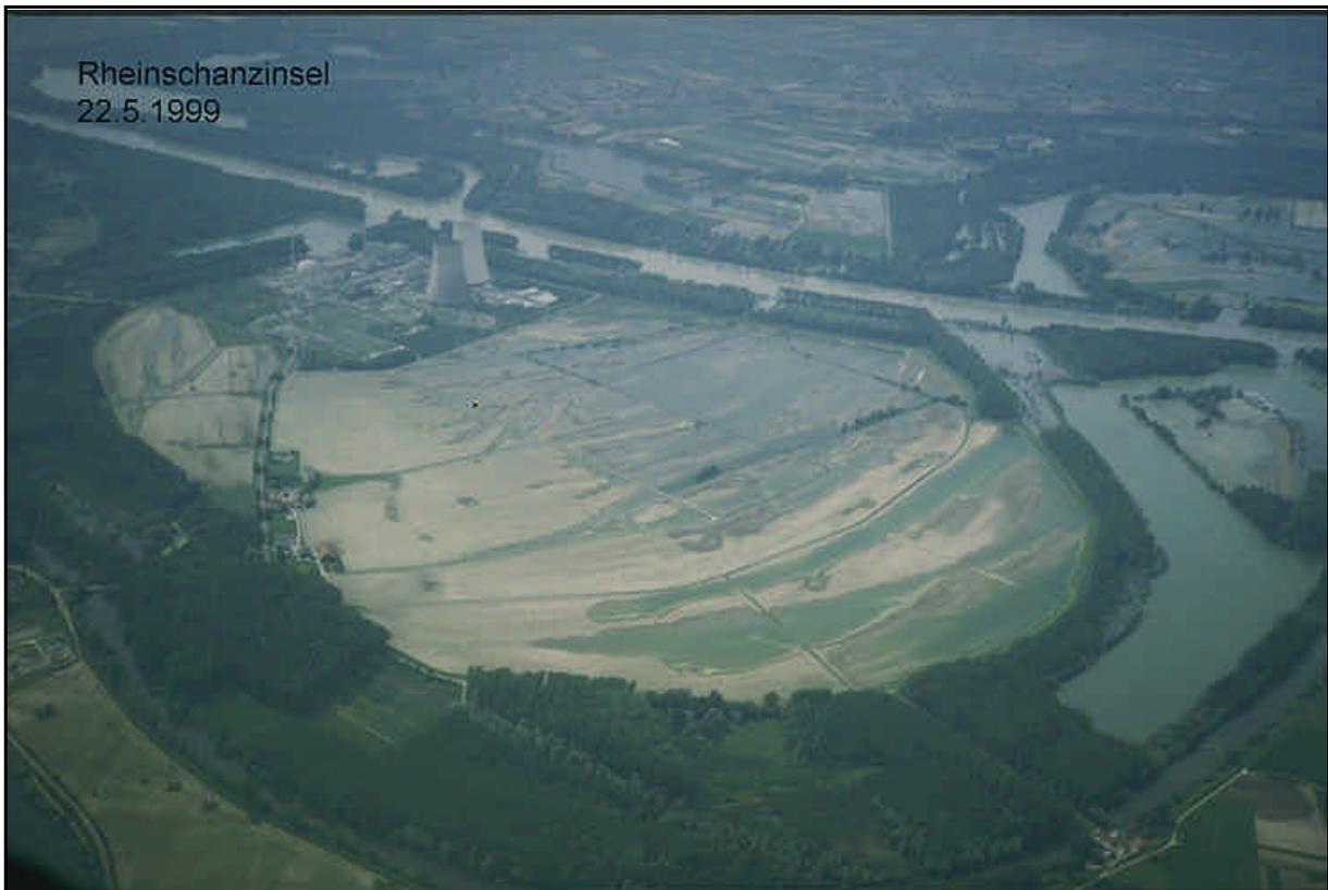
**Abb. 72.:** Großflächige Druckwasser auf der Rheinschanzinsel. Links zeichnet das Druckwasser den Verlauf der einstigen Gräben des Brückenkopfes der Festung Phillipsburg nach.
