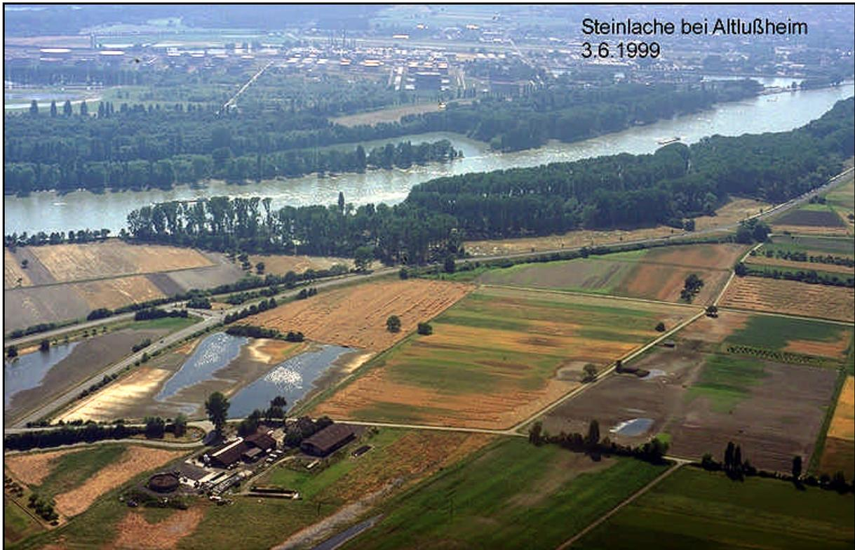
**Abb. 69.:** Restwasserflächen und Ernteschäden zeigen das Ausmaß der Drückwasserflächen am nördlichen Ortsausgang von Altlußheim auch noch am 25.6.1999 deutlich an.
