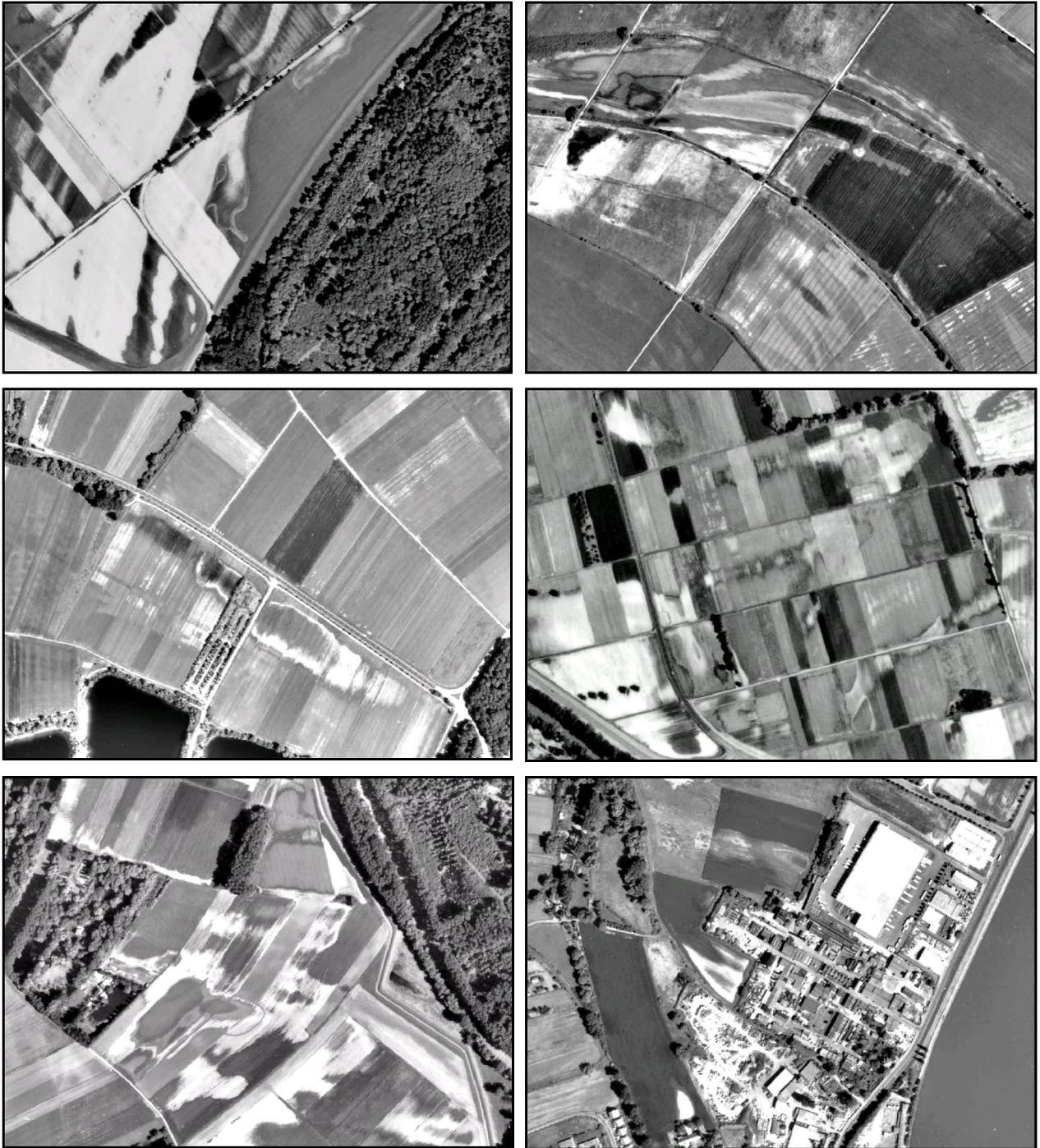
**Abb. 41.:** Beispiele für die Abbildung von druckwasserbedingten Ernteschäden bzw. Veränderungen der Vegetation im Untersuchungsgebiet. Bei den hellen Flächen handelt es sich zumeist um abgestorbene und vergilbte Pflanzen, bei den dunklen Flächen im Inneren der Inundationsflächen um sukzessive nachwachsende, feuchtigkeitsliebende Pflanzenarten. Die Bilder entstanden mehr als 2 Monate nach dem Maximum der Hochwasserwelle.
