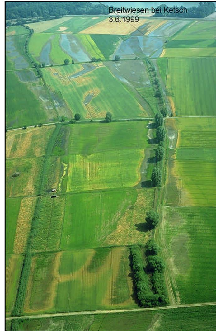
**Abb. 67.:** Druckwasserflächen im Bereich der Breitwiesen südlich von Ketsch am 3.6.1999. An den Veränderungen in der Vegetation lässt sich im Luftbild auch nach dem Rückgang des Wassers das maximale Ausmaß der Inundationen erfassen.
