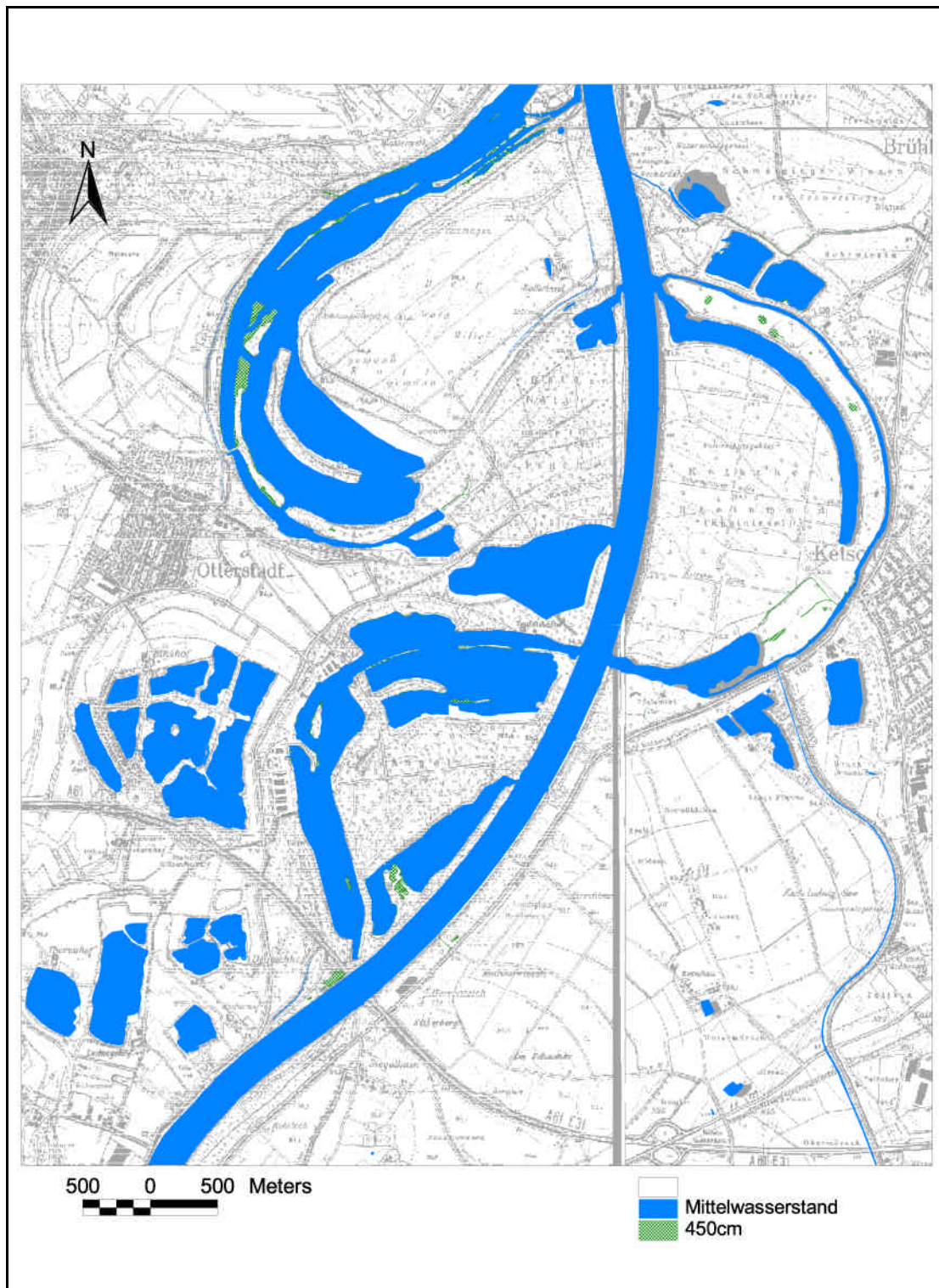
Abb. 138.: Ergebnisdarstellung: Inundationsflächen bei Wasserständen von 450cm am Pegel Speyer. Bei den Überschwemmungsflächen handelt es sich in erster Linie um Schilfflächen.
