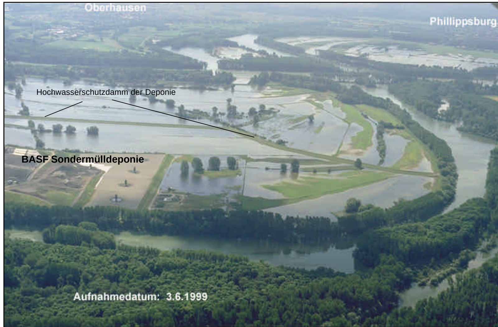
Abb. 128.: Die Insel Flozgrün im Juni 1999. Im Vordergrund ist die Sondermülldeponie der BASF zusehen. Trotz des Hochwasserschutzdammes sind auf dem Gelände großflächige Druckwasseraustritte bzw. Sickerwassersammelflächen zu erkennen. Im Hintergrund großflächige Wasseraustritte auf der Rheinschanzinsel neben dem Atomkraftwerk Philippsburg.
