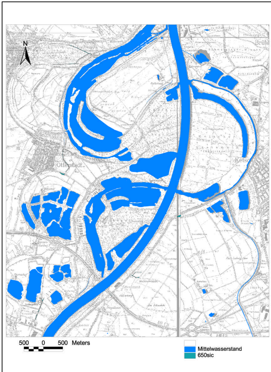
Abb. 146.: Ergebnisdarstellung: Potenzielle Sickerwassersammelflächen bei Wasserständen von 650cm am Pegel Speyer. Quelle: Eigene Abbildung
