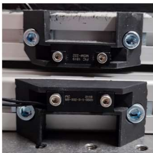
Abbildung 24: Magnetschutzschalter mit gedruckten Halterungen zum Personenschutz bei eingeschaltetem Laser.
