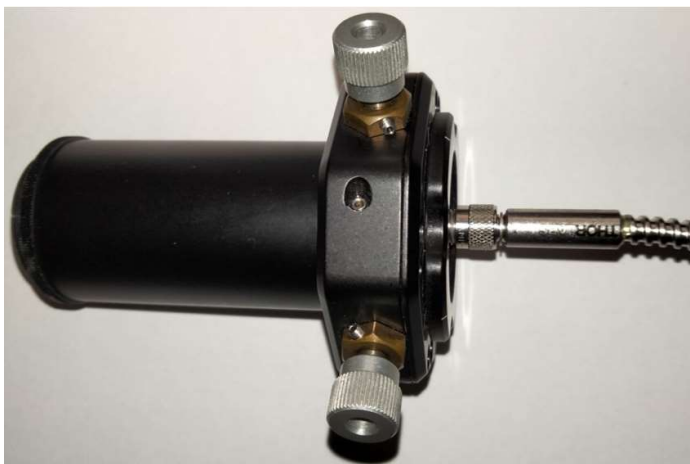
Abbildung 28: Spektrometeradapter der Glasfaser an dem Filterrad zur Einkopplung der Messsignale in das Spektrometer.
