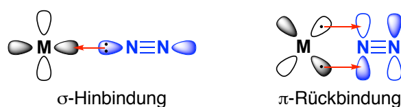
Abbildung 2.5.01: Interaktion der Molekülorbitale für \text{N}_2 -Übergangsmetall-Wechselwirkung im end-on-Modus von mononuklearen Metallkomplexen mit d-Orbitalen, Dewar-Chatt-Duncanson-Model. Bildquelle: Erstellt mit ChemDraw Professional.
