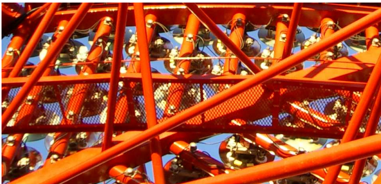
Abbildung 3.6: Links: Blick von hinten auf einen Teil des Spiegelträgers. Die einzelnen Spiegel sitzen auf Metallrohren. Rechts: Blick von hinten auf einen Spiegel. Man erkennt die beiden Aktuatoren sowie das verwindungssteife Aluminium-Dreieck, auf das der Spiegel geklebt ist.
