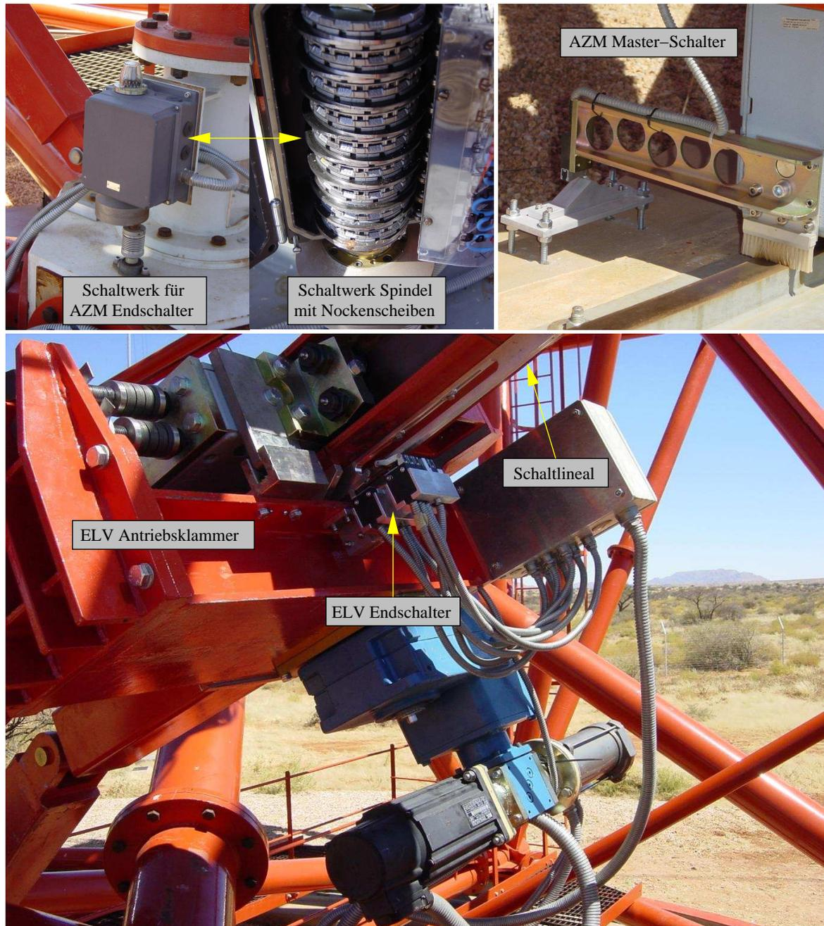
Abbildung 2.21: Lage und Ausführung der Endschalter-Systeme. Unten Elevationsendschalter betätigt durch Schaltlineale. Oben links: Azimut-Schaltwerk am Zentrallager. Oben mitte: Azimut-Schaltwerk geöffnet. Oben rechts: Azimut Master-Schalter für Parkposition.
