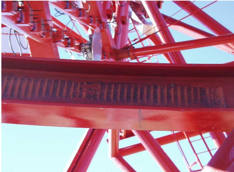
Abbildung 2.18: *Spuren einer missglückten Bremsung bei hohem externem Drehmoment und nicht optimierten Regelparametern.*
