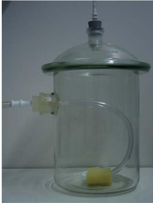
Abbildung 7.2: Luftbefeuchter vor dem Befüllen mit Sand und Wasser. Während des Experiments wird der trockene Stickstoff seitlich eingeleitet und strömt am Exsikkatorboden aus dem Schlauch durch einen Schwamm und dann durch den feuchter Sand nach oben
