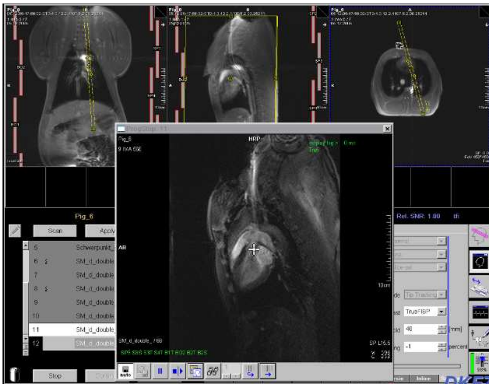
Abb. 4.19: Arbeitskonsole während der Intervention, wie sie bei den Tierversuchen verwendet wurde. Im oberen Teil sind drei Übersichtsbilder zu sehen, in der die aktuelle Meßschicht (gelber Rahmen) eingezeichnet ist, sich aber auch interaktiv neu orientieren lässt. Im zentralen Bereich ist das Echtzeitfenster, in dem die aktuelle Messung präsentiert wird, (in diesem Fall eine Katheterintervention ins Herz). Das weiße Kreuz markiert die Katheterspitze.
