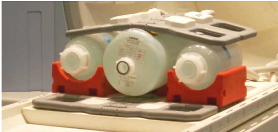
Abb. 4.4: Der Meßaufbau des Phantomexperiments ist ähnlich dem Meßaufbau der Tierexperimente. Unter den Kalibrationsflaschen befindet sich eine 6 Kanal posterior Bodyarray-Spule und darüber eine 6-Kanal anterior Spule. Durch diese Konfiguration ist es möglich, Parallele Bildgebung ( AF = 2 ) bei beliebiger Schichtorientierung zu nutzen.
