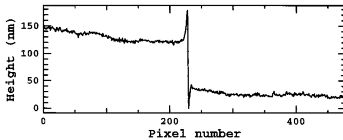
Abb. 5-4: Interferometrisch bestimmtes Profil einer 80 nm hohen Stufe. Die Messung von A. Harasaki und J. C. Wyant 96 zeigt exemplarisch die Überhöhung des Profils durch Beugung an Kanten.
