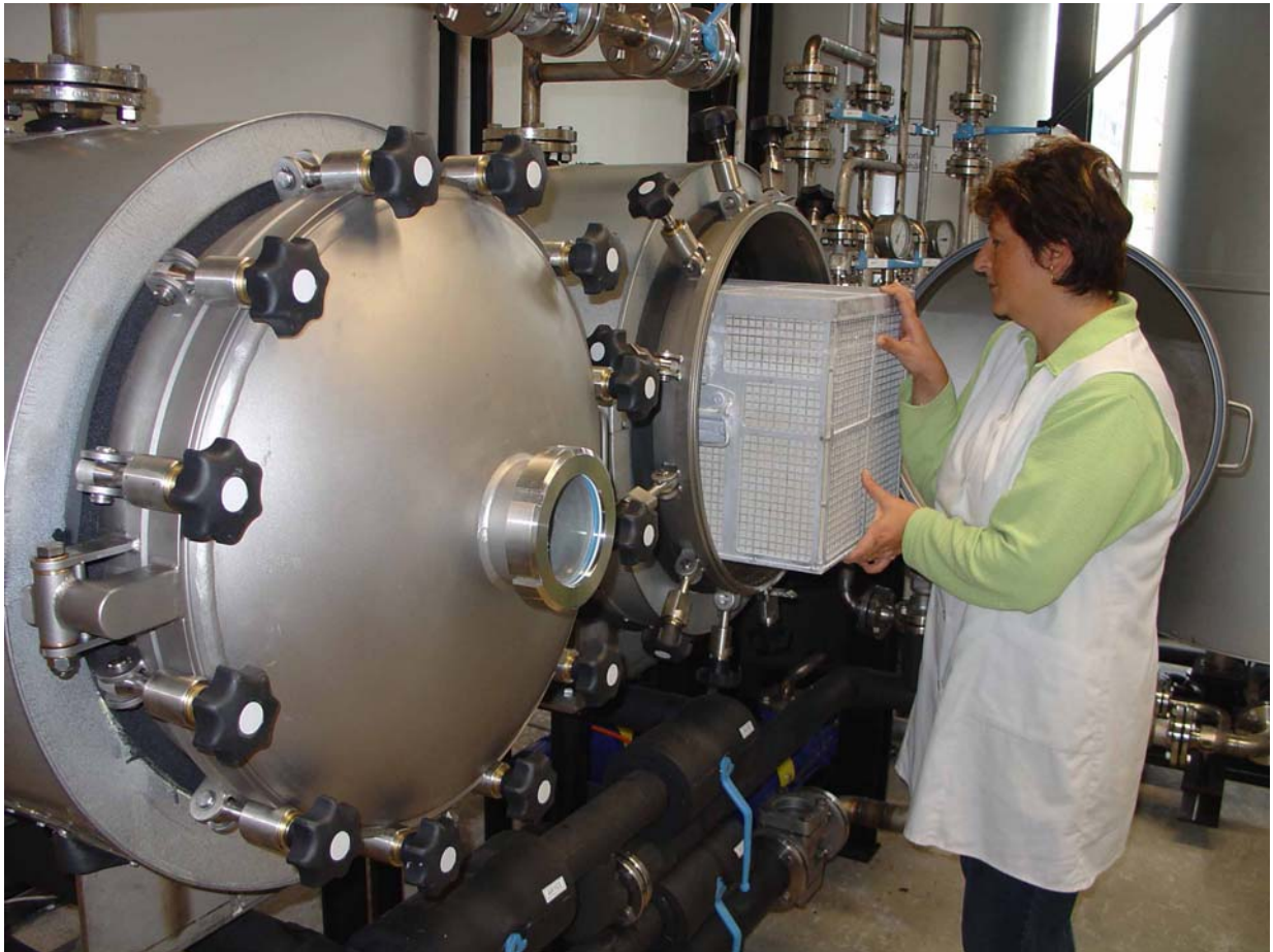
Massenentsäuerung Preservation Academy Leipzig
