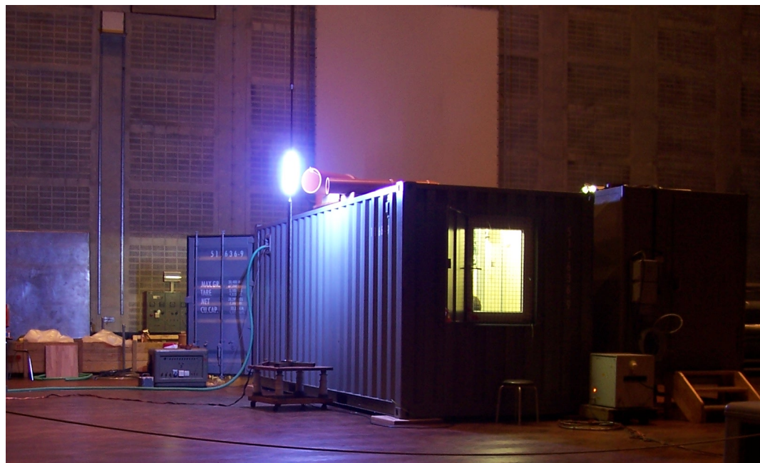
Abbildung 8.25: Lichtbogenaufnahme während der Kampagne im Versuchslabor der TU-München. Ebenfalls zu sehen sind der Messcontainer des MPI-K, das Einlasssystem und die Elektroden für die Entladung.
