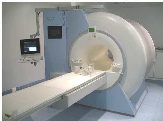
Abb. A.2: (a) Eine am DKFZ gebaute Sende-Empfangs-Kleintierspule, die (b) auf der Patientenliege eines klinischen Ganzkörper-MR-Tomographen positioniert ist. Der innere Durchmesser der Spule beträgt 26 mm. Sie ist 100 mm lang.
