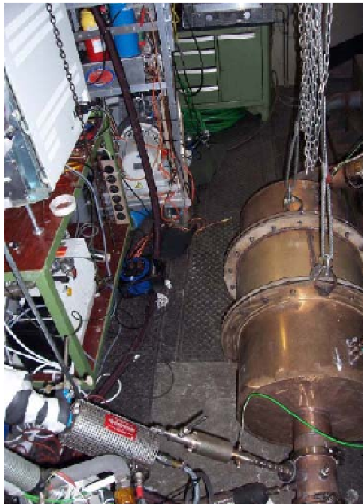
Abbildung 5.1: Bild der Abgasnachbehandlungstrommel am Teststand. Auf der linken Seite ist die Dekati-Verdünnungsstufe und das CIMS-Instrument mit Einlasssystem zu sehen.
