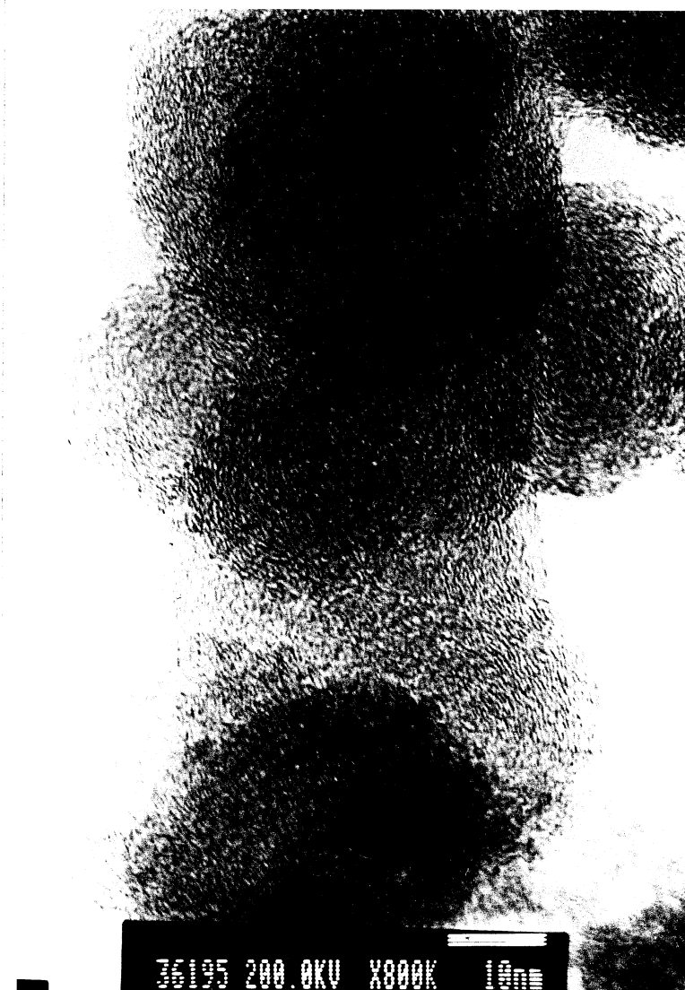
Abb. 1.8 TEM-Aufnahme eines Rußpartikels aus einem Flugzeug-Strahltriebwerk (Popovitcheva (2000))
