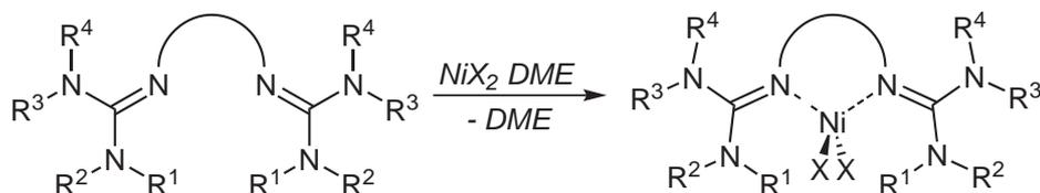
**Abbildung 3.2.1.** Allgemeines Schema der Syntheseroute der Bisguanidin-Nickel(II)-Komplexe (X = Cl, Br, DME = 1,2-Dimethoxyethan,  $\text{R}^1\text{-R}^4 = \text{Me}$  oder  $\text{R}^1 = \text{R}^4 = \text{Me}$  und  $\text{R}^2, \text{R}^3 = -\text{CH}_2-\text{CH}_2-$ ).
