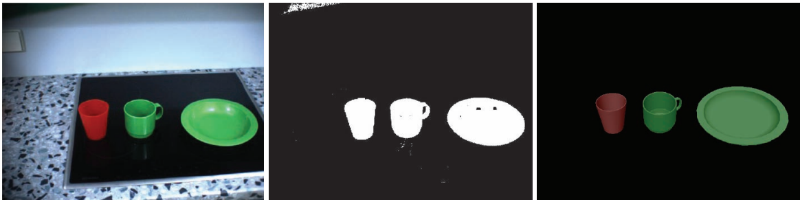
Abbildung 2.2: Farbsegmentierung (Mitte) und Ergebnis der Lokalisation (rechts) mittels der korrelationsbasierten Methode aus (AAD06).
