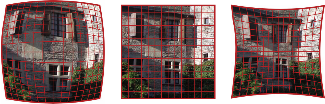
Abbildung C.2: Unverzerrtes Bild (Mitte), tonnenförmige Verzerrung (links) wie sie oft durch Weitwinkelkameras entsteht und kissenförmige Verzerrung (rechts), jeweils mit überlagerter Verzerrungsmaske.
