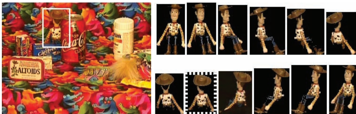
Abbildung 2.3: Beispiel der Objektdetektion mittels des Verfahrens aus (CK99). Links ist ein erfolgreich gefundenes Objekt in einer komplexen Szene eingezeichnet, das durch CCH's der rechts abgebildeten Ansichten repräsentiert wird. Aus (CK99) entnommen.
