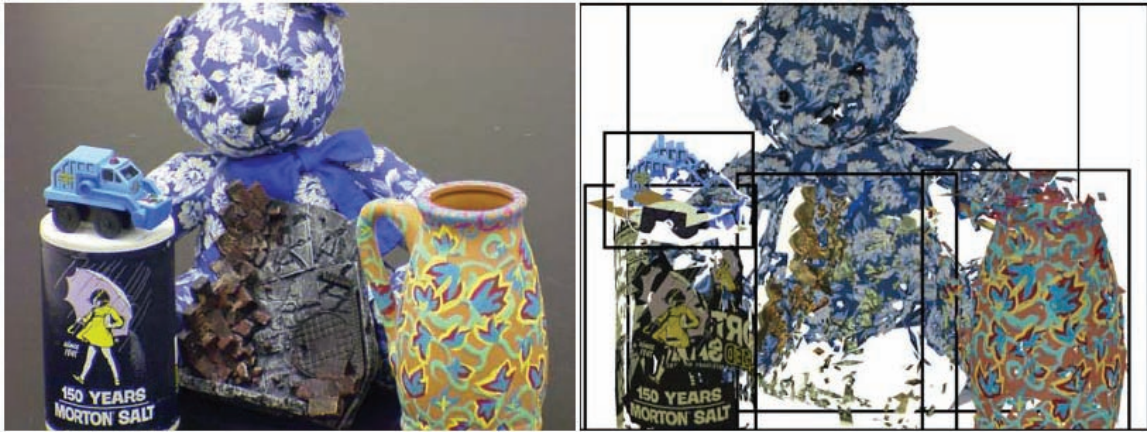
Abbildung 2.5: Objektklassifizierung mittels rektifizierter lokaler Bildpatches aus (RLSP06).
