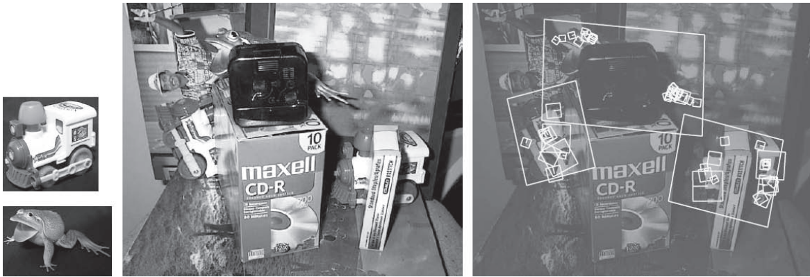
Abbildung 2.4: Objektklassifikation mittels SIFT-Merkmalen und dem Verfahren aus (Low99). Links sind die zwei Trainingsbilder dargestellt, rechts die gefundenen Instanzen in einer komplexen Szene. Die großen Vierecke zeigen die affin transformierten Ansichtsgrenzen, die kleinen Rechtecke die verwendeten SIFT-Merkmale. Aus (Low04) entnommen.
