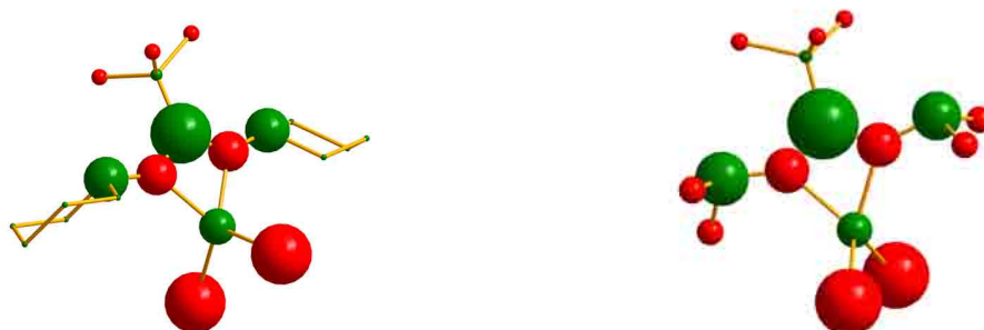
Abbildung 4.18: Ladungsverteilung in 11 (links) und 13 (rechts). Die Wasserstoffatome wurden der Übersichtlichkeit halber entfernt. Rot bedeutet negativ geladen, grün positiv. Der Durchmesser der Kugeln entspricht der Ladung mit 1 \text{ \AA} \cong 0.1 e .
