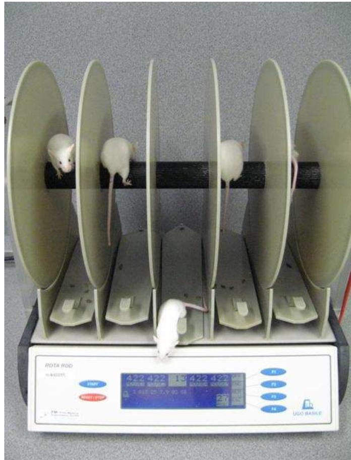
**Abbildung 12 Maus Rotarod.** Beim Rotarod handelt es sich um einen sukzessiv schneller um die Längsachse rotierenden Stab, mit dem die motorischen Fähigkeiten sowie die Ausdauer der Tiere bestimmt werden können.
