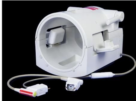
**Abb. 5.2:** Außenansicht der  $^{17}\text{O}$ -Birdcage-Kopfspule mit Spulensteckern, Fixierungshilfen zur stabilen Positionierung des Kopfes und Hebelmechanismus zum Öffnen der Spulenseite.
