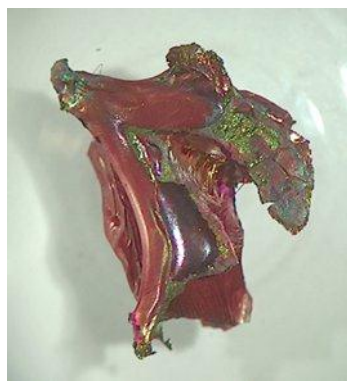
Abbildung 61: Polymer 187 nach einer Quellung in einer Dichlormethanolösung von Rhodamin B und anschließendem Verdampfen des Lösungsmittels
