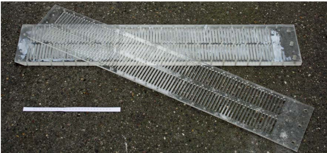
Abbildung 13 Porenwasserprobenahmegerät ("Peeper"), oben schematische Darstellung, unten Photo ( Länge Maßstab 30 cm)
