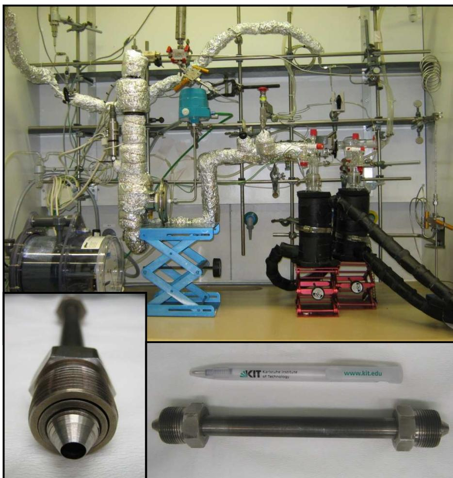
**Abbildung 11:** Laboranlage und Festbettreaktor zur Bestimmung der Katalysatoraktivität in der Umsetzung von Synthesegas.
