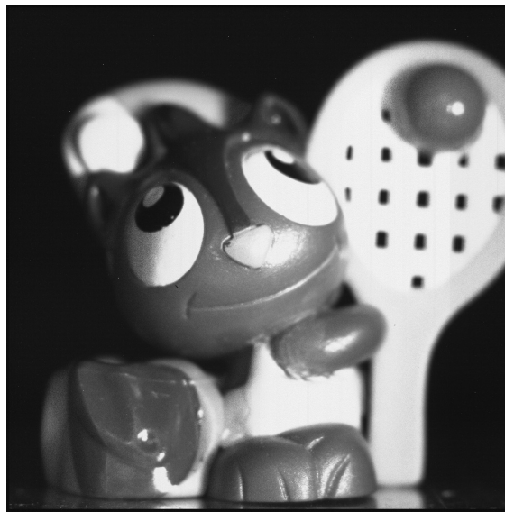
Abbildung 5.6: Unkorrigiertes (nur DCDS) Grauwertbild, das mit der FLICAM ohne Modulation aufgenommen wurde.
