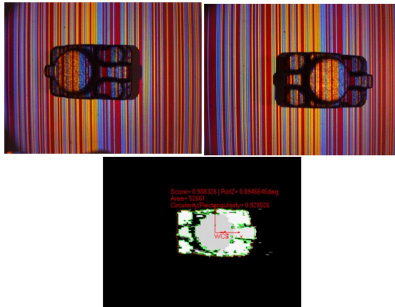
Abbildung A.32: o.: Beispielbildpaar des Bauteils Nummer 104 (Gußteil) mit Streifenmusterbeleuchtung; u.: rekonstruiertes Tiefenbild (Grauwert entspricht dem Tiefenwert), Abb. aus Halcon
