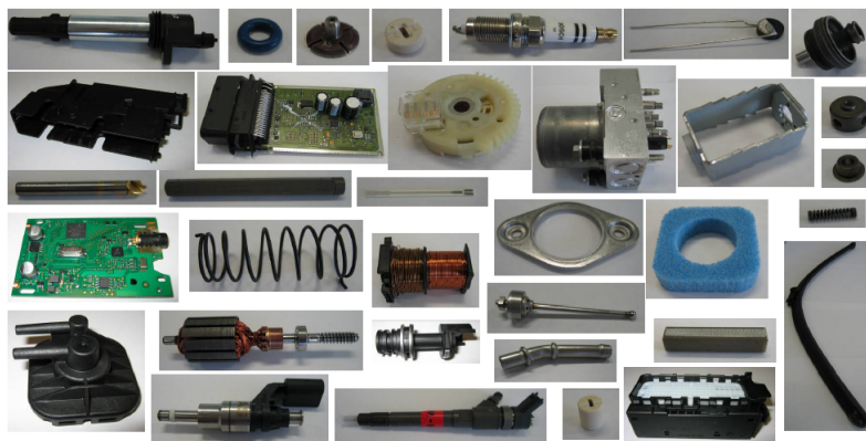
Abbildung 3.1: Bauteilekoffer: 34 typische Bauteile, die das Anforderungsspektrum für die Objektlageerkennung bei Bosch möglichst gut wiedergeben (siehe [Say11])
