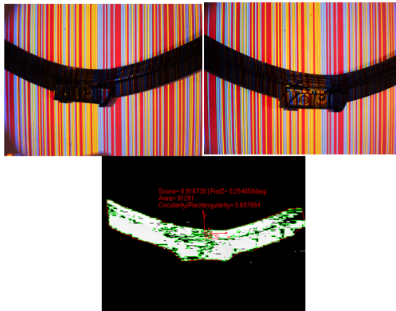
Abbildung A.27: o.: Beispielbildpaar des Bauteils Nummer 33 (Wischer) mit Streifenmusterbeleuchtung; u.: rekonstruiertes Tiefenbild (Grauwert entspricht dem Tiefenwert), Abb. aus Halcon
