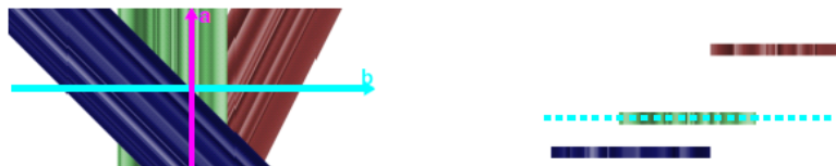
Abbildung 5.5: x - \Phi_X -Lichtfeldschnitt (links) einer Szene mit drei Objekten (rechts) (Abbildung aus [AL08b])
