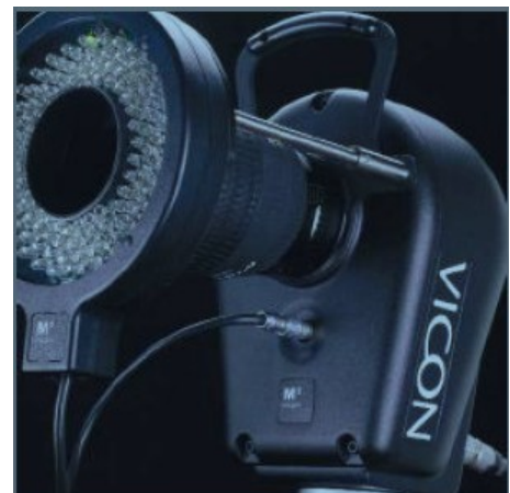
Abb. 25: Vicon© Kamera mit Ring aus Leuchtdioden.
