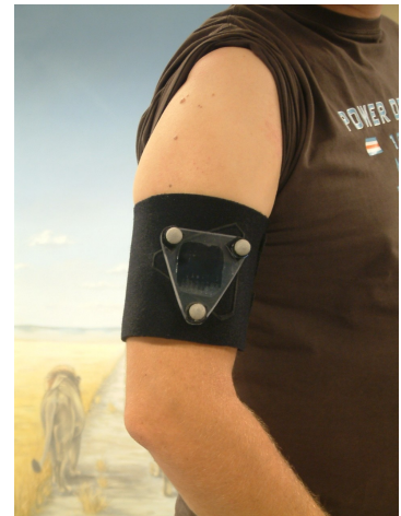
Abb. 24: Markercluster, fixiert auf einer Plexiglas scheinbe mit einer flexiblen Manschette am Oberarm befestigt.
