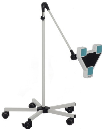
Abb. 11: CMS10 System der Firma Zebris; Ultraschall-empfänger.
