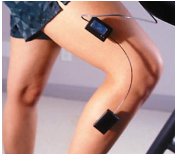
Abb. 9: S700 Joint Angle Shape Sensor™ (Optischer Sensor) der Firma Measureand; Bestimmung der sagittalen Kniekinematik.
