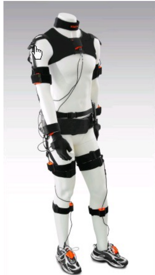
Abb. 14: Bewegungsanalysesystem MVN BIOMECH der Firma XSENS.
