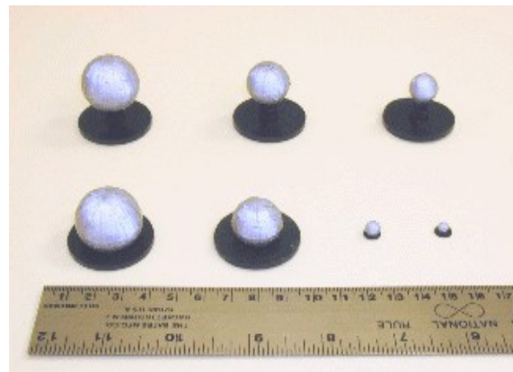
Abb. 13: Passive Marker in verschiedenen Größen, kugelförmig, beklebt mit spezieller stark reflektierender Klebefolie.
