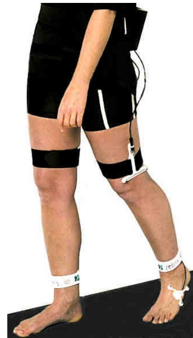
Abb. 12: CMS10 System der Firma Zebris; Jeder Marker umfasst drei Ultraschall-Transmitter.
