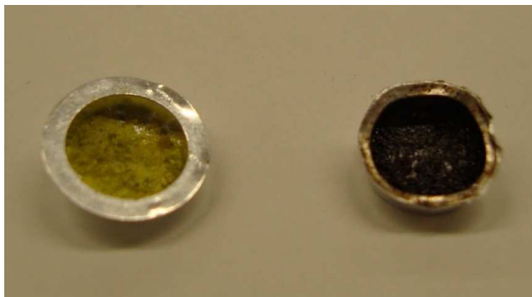
Abb. 95 : Verbindung 3/[PPh_3AuCH_2CN]_2 vor (links) und nach (rechts) dem Erhitzen auf 250 °C.
