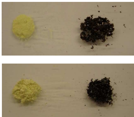
Abb. 59 : [1(\text{AgBr})_2]_n (oben) und [1(\text{AgI})_2]_n (unten) vor und nach dem Erhitzen auf 720^\circ\text{C} .
