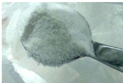
Abbildung 5.1: Elektrostatische Wechselwirkungen bei der Entnahme von Pulver (hier: Avicel PH101) mit einem metallischen Gegenstand z.B. einem Löffel.
