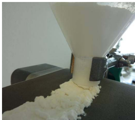
Abbildung 4.10: Links: In Siebmaschine eingespannter Trichter. Rechts: Ausfließen des Pulvers für die Probennahme (s. auch Abbildung 4.9).
