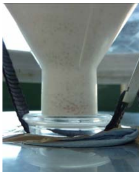
Abbildung 4.12: Der Trichterauslauf ist mit einem Stuhlgleiter verschlossen und mit einem Zurrurt fixiert.
