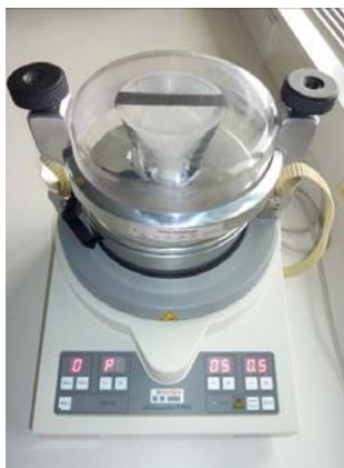
Abbildung 4.10: Links: In Siebmaschine eingespannter Trichter. Rechts: Ausfließen des Pulvers für die Probennahme (s. auch Abbildung 4.9).
