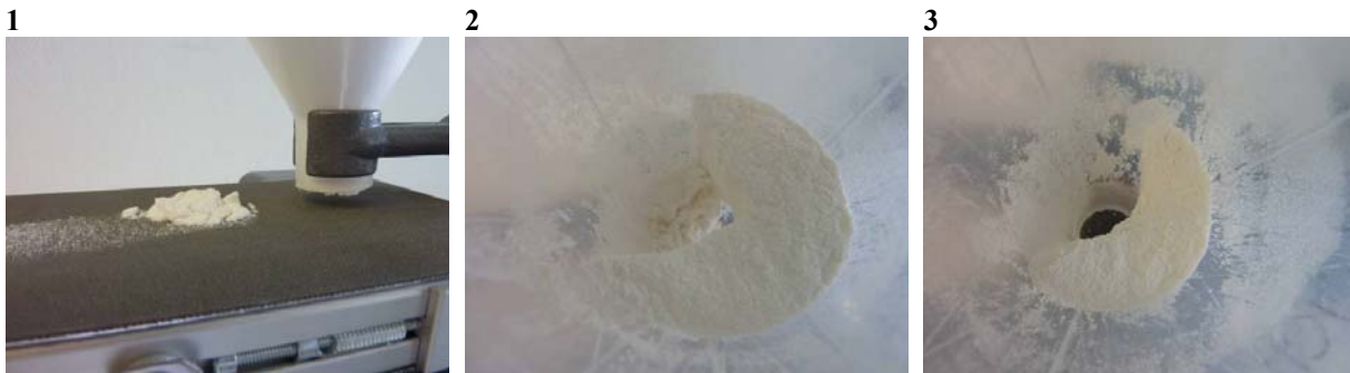
Abbildung 5.82: Aufnahmen des Ausfließens aus dem Trichter nach der Vibration.
