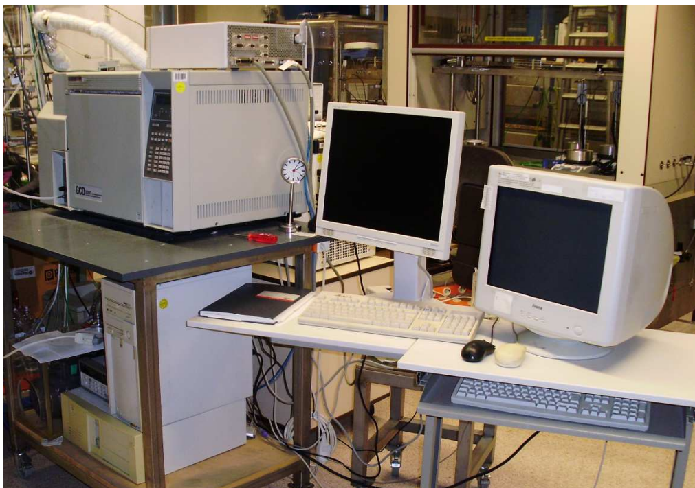
Abbildung 17: Steuerung der kontinuierlich betriebenen Laboranlage zur Synthese von leichten Olefinen.
