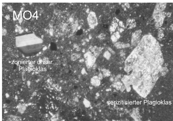
Abbildung 4.15: Dünnschliffbild der Probe MO4 unter polarisiertem Licht, Bildbreite 2.5 mm
