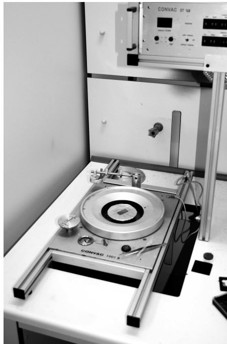
Abbildung A.1: Für die großflächigen Beschichtungen installierter Schleuderbeschichter Convac 1001 S. Zunächst in einem begehbaren Abzug installiert (Bild), später in einen Reinraum transferiert.
