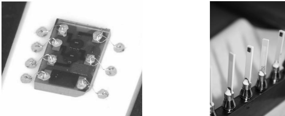
Abbildung 6.2: Links: Ein mit goldhaltigem Glaslot aufgefügter und mit Golddrähten zum Keramikträger gebondeter ChemFET. Rechts: Mit hochtemperaturfestem Klebstoff in Swagelok-Rohrstücke eingefügte Keramikträger mit aufgefügten ChemFETs.
